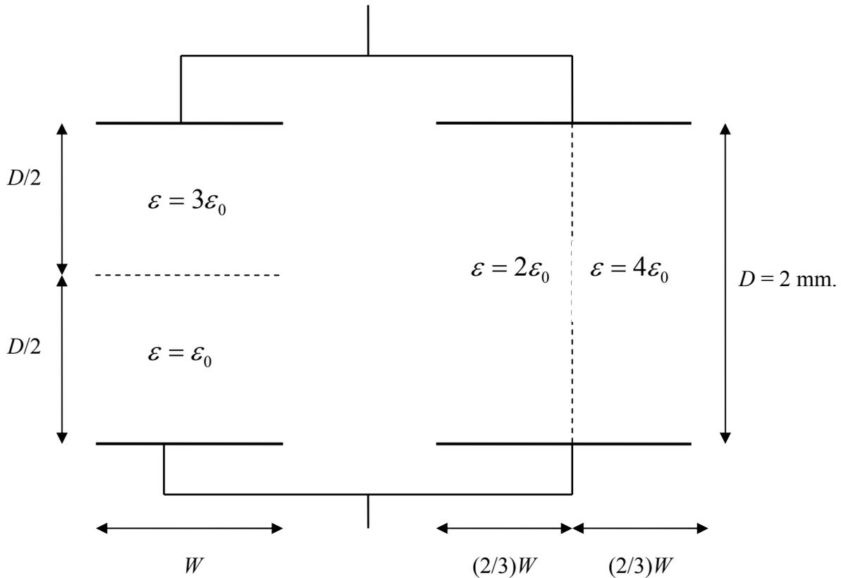
La struttura è equivalente al parallelo di due capacità,  $C_1$  (a sinistra in figura) e  $C_2$  (a destra in figura), le quali sono rispettivamente uguali alla serie e al parallelo di due ulteriori capacità.
